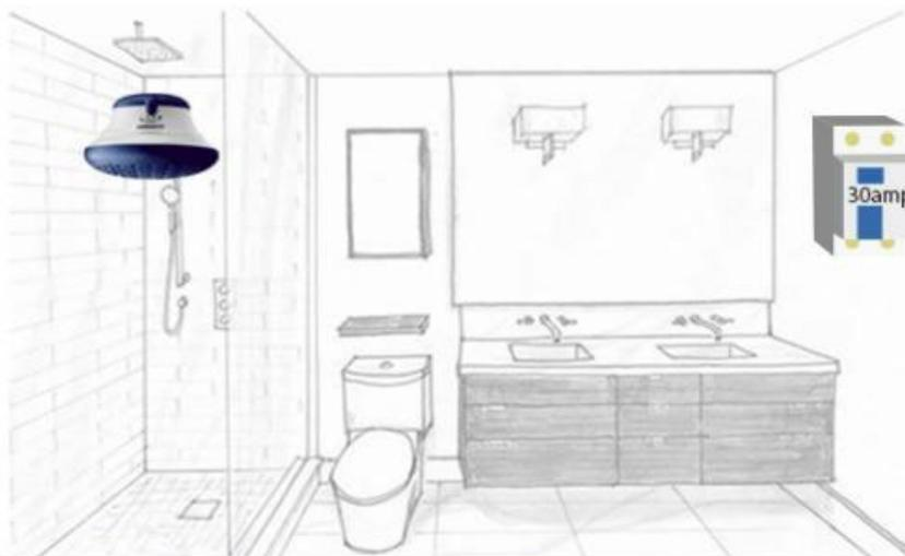
3) Realizar la puesta a tierra (cable verde) fuera del punto del baño. Conecte los cables de corriente a la ducha (cables blancos).
